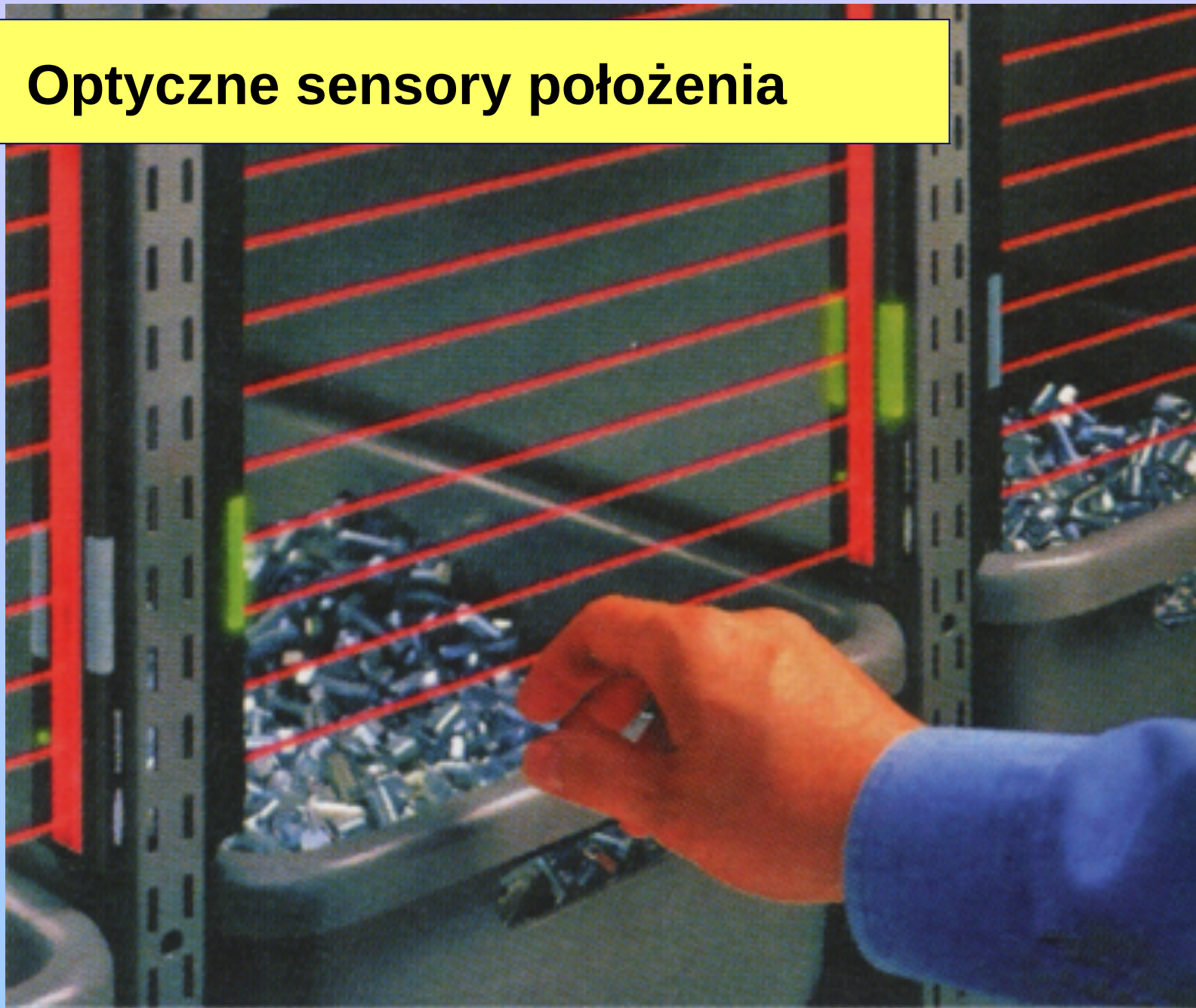
Rys. 1. Optyczna kurtyna zabezpieczająca
